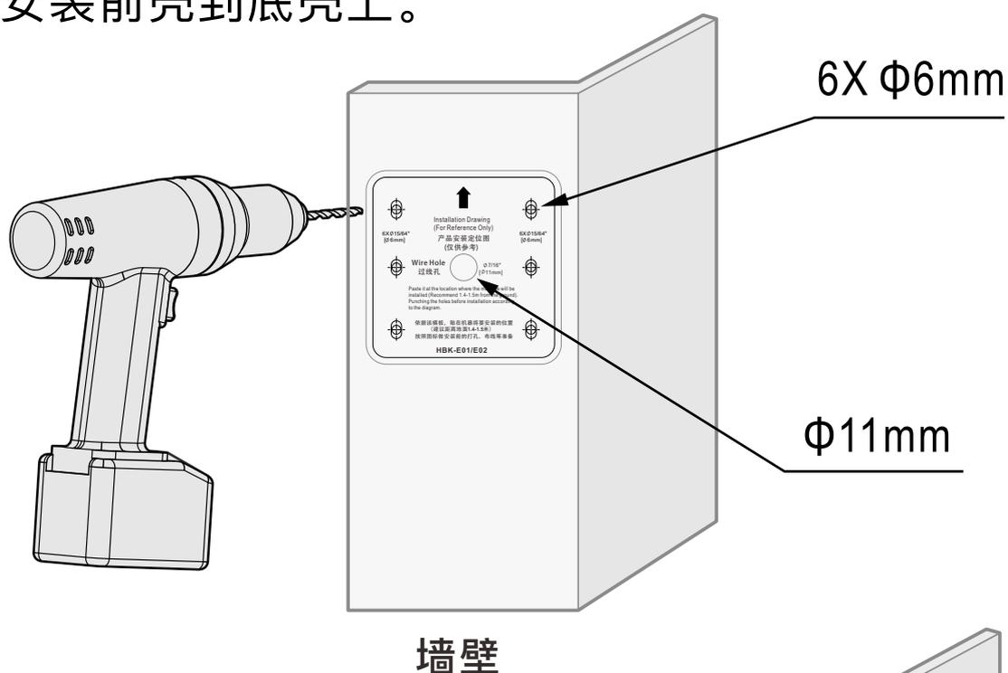
图2-安装膨胀管
